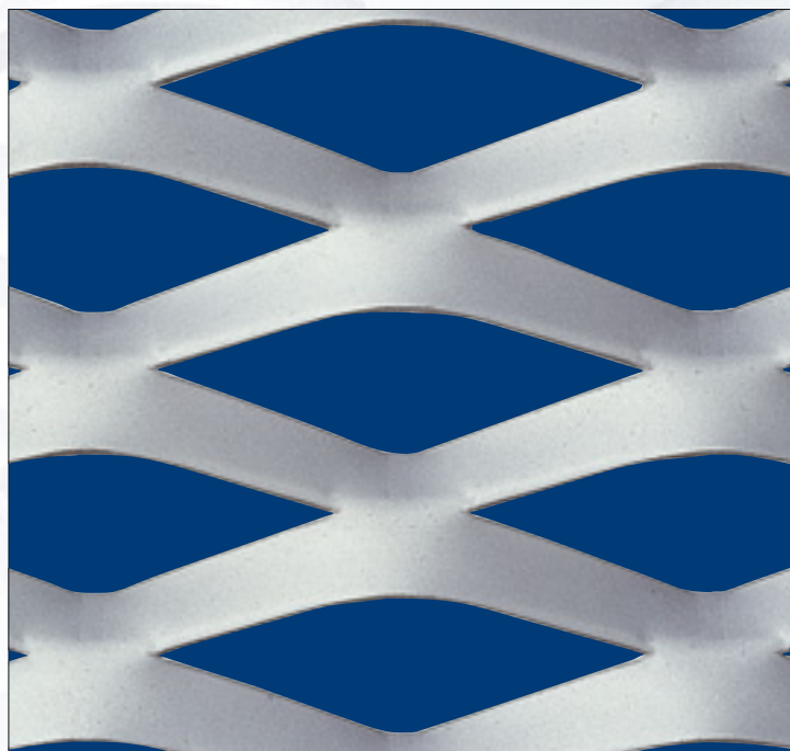
Gate - DL 76 x DC 31 (35) - av 11 x sp 1.5 mm
